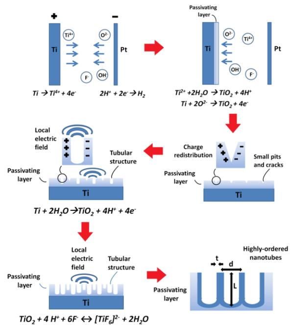
$t$ : wall thickness,  $d$ : tube diameter,  $L$ : tube length
