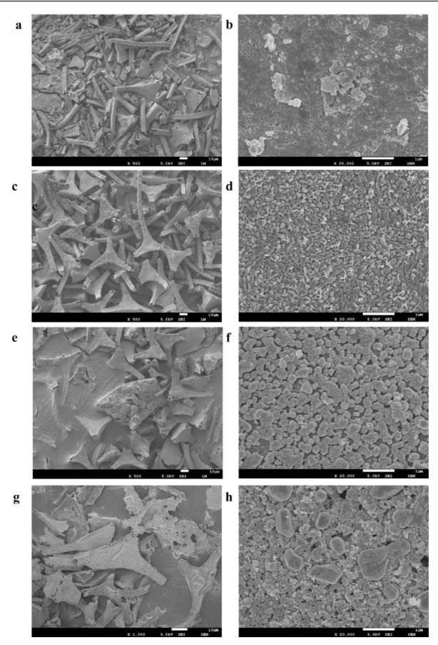
*Fig. 2. SEM images of samples: (a-b) CoSe*<sub>2</sub>/C-700 °C, *(c-d) CoSe*<sub>2</sub>/C-800 °C, *(e-f) CoSe*<sub>2</sub>/C-900 °C and *(g-h) CoSe*<sub>2</sub>/C-1000 °C
